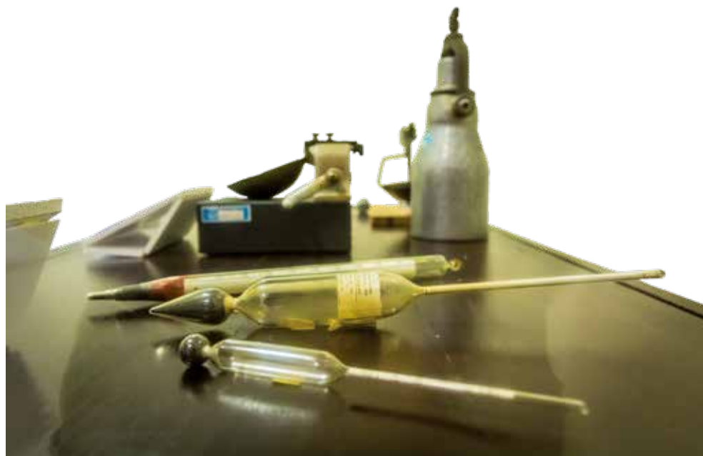
Alcoholímetro e higrómetro para la medición de alcohol en disoluciones y humedad en el aire respectivamente
