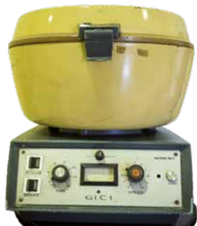
Centrífuga, empleada para separar sedimentos
