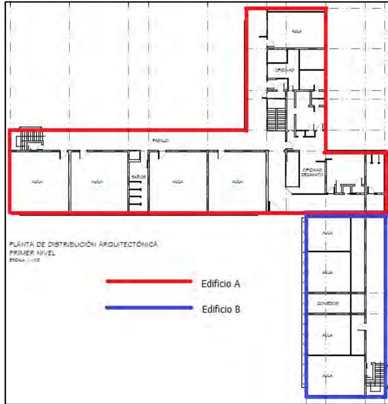
Figura 3-8. Delimitación de las estructuras de estudio separadas por junta de construcción
