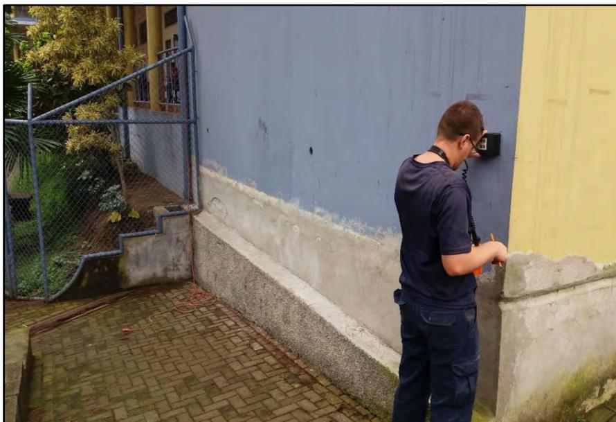
Figura 3-37. Procedimiento de detección de barras de acero
