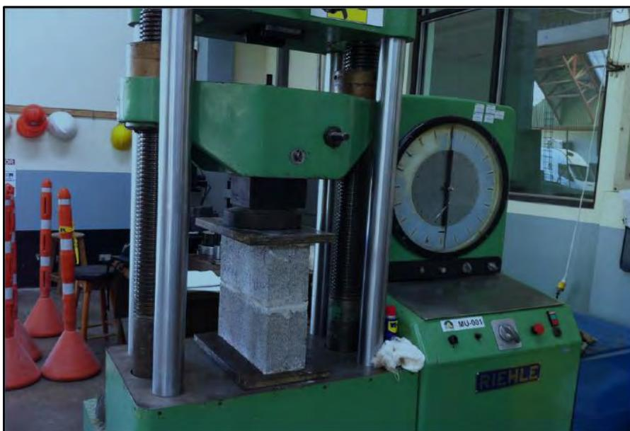
Figura 3-36. Falla de un prisma de mampostería
