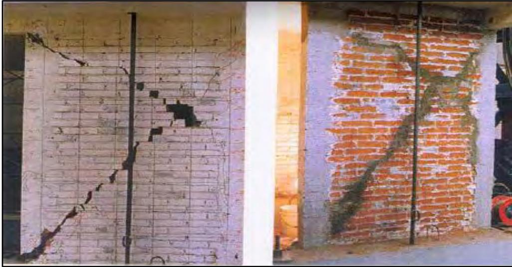
Figura 6-4. Muro de mampostería confinada antes y después de la preparación de la superficie para la colocación de la malla electrosoldada
