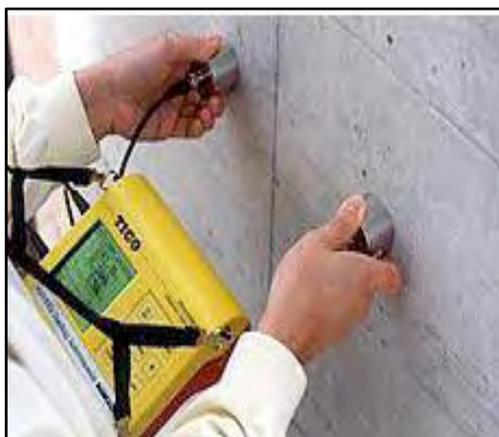
Figura 3-35. Equipo de ultrasonida para elementos de concreto
