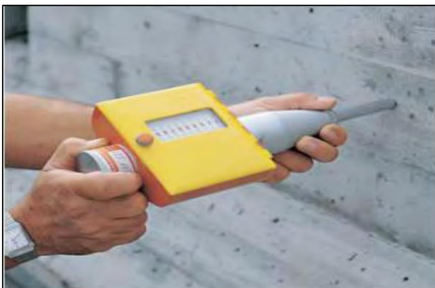
Figura 3-34. Procedimiento de ensayo con esclerómetro
